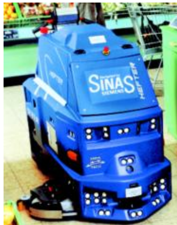
Abbildung 1: Reinigungssystem auf der Basis eines mobilen Roboters
