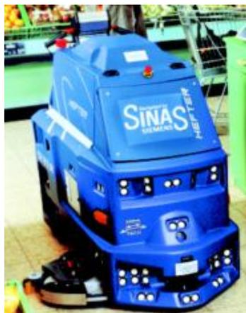
Abbildung 1: Reinigungssystem auf der Basis eines mobilen Roboters
