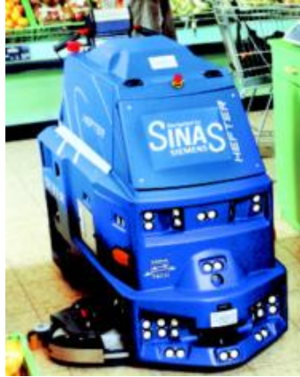
Abbildung 1: Reinigungssystem auf der Basis eines mobilen Roboters [Siemens - SINAS Website]
